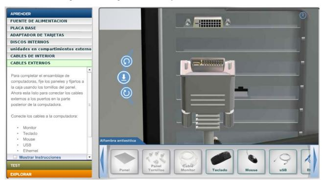
Conectaremos todo lo del panel posterior, empezaremos por el conector DVI del monitor. Haremos lo mismo con el teclado y ratón, el cable de red y el cable de alimentación.
