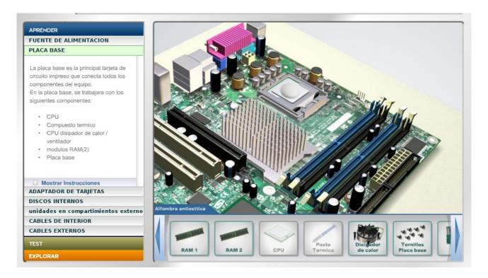
Hemos instalado el microprocesador, y lo hemos asegurado. Despues le hemos puesto pasta térmica.
