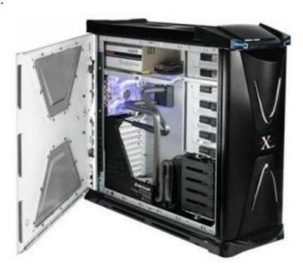
La carcasa es una estructura de plástico o de metal cuya funcion es la de ostentar los componentes del ordenador, así como proporcionarles una buena distribución y refrigeración.
