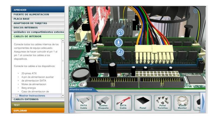
Una vez hemos puesto el disco duro y la unidad optica vamos a conectar el hardware en la placa base, empezamos por el conector de 20 pines de la fuente de alimentacion.
